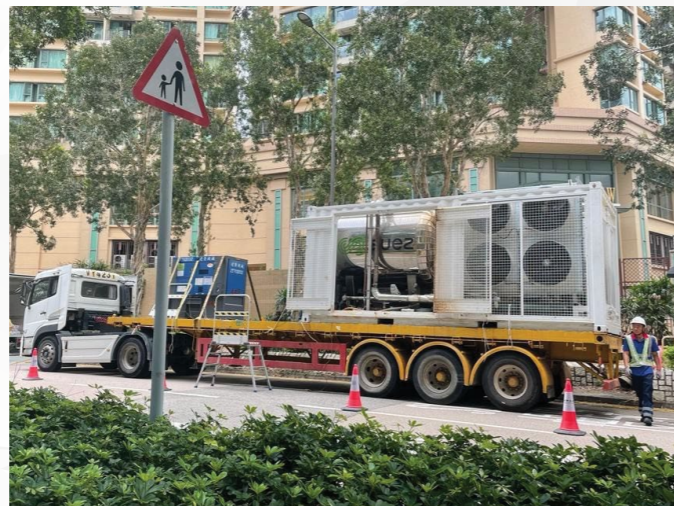
圖一：碎冰清管設備
