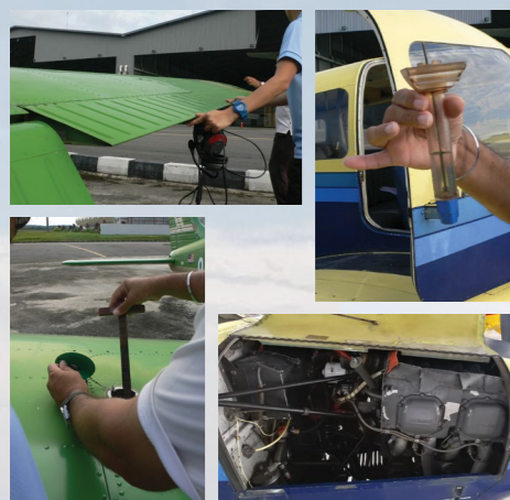
每次飛行前，都要親自檢查飛機一次(Walk Around) (左上)檢查襟翼及副翼運作正常 (右上)檢查燃料有無雜質 (左下)檢查燃料容量 (右下)檢查引擎有無鬆脫同異物
